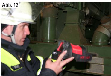
Abb. 12 Temperaturüberwachung und Kontrolle im Bereich der Fördertechnik mittels Wärmebildkamera
